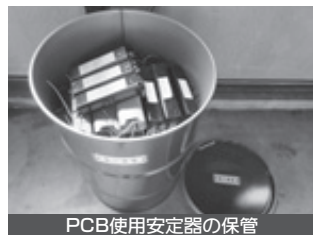
PCB使用安定器の保管
